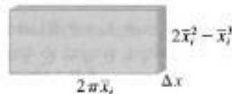
FIGURE 15 Le tube mis à plat
